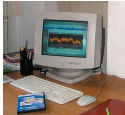
Energy2120 installato presso il prosciuttificio A. Fontana. Monitoraggio continuo, storicizzazione ed elaborazione dei dati raccolti attraverso il modulo software per supervisore PVENGMBLD0
