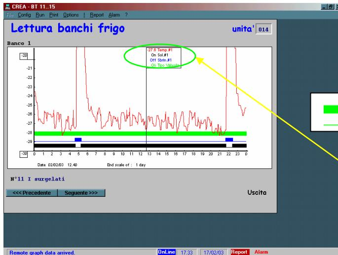
Abb. 14: Vergrößerung auf TAGESBASIS der Betriebstemperatur der Tiefkühlinsel Nr. 11 mit ELEKTRONISCHEM VENTIL.
