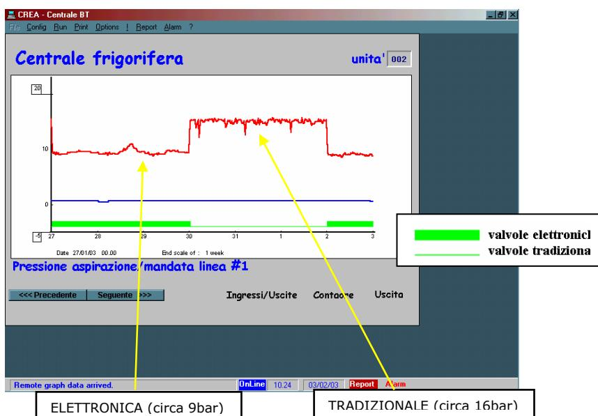
Fig. 11: Dati sulle pressioni dei compressori della centrale frigorifera BT relativi alla SETTIMANA 27gen-3feb 2003
