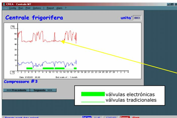
Como para la central BT, también para la TN la temperatura de descarga resulta INFERIOR, en los periodos de funcionamiento de las válvulas electrónicas
