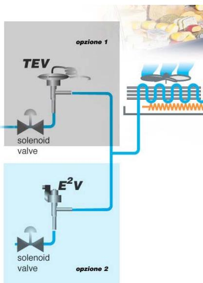
Su ciascuna delle utenze frigorifere (banchi e celle) è stato installato un **doppio circuito parallelo** gestito da elettrovalvole, che in qualunque momento possono far funzionare l'utenza in una tecnologia o nell'altra. In questo modo è possibile confrontare le due tecnologie (TEV e EEV) a parità di tutte le altre condizioni di utilizzo.
