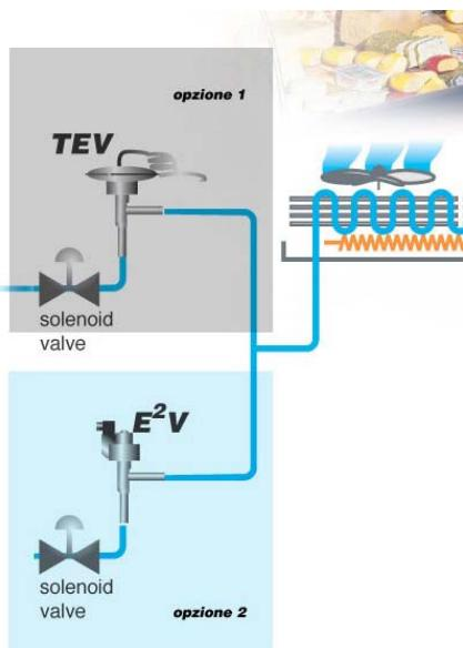
In jedem Kühlgerät wurde ein **parallel geschalteter, doppelter Kältekreis** installiert, der über Elektroventile in der gewünschten Technologie gesteuert werden konnte, um beide Betriebsmodi (TEV und EEV) zu denselben Betriebsbedingungen zu vergleichen.
