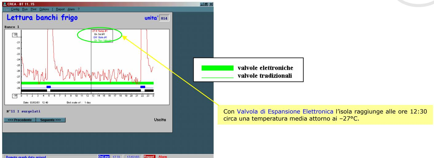
Fig. 14: Ingrandimento su scala GIORNALIERA della temperatura di lavoro dell'isola surgelati n°11 funzionante con VALVOLA ELETTRONICA.
