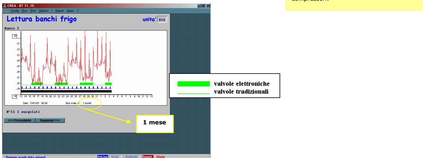
Fig. 13: Temperature di lavoro isola surgelati n°11 nel PERIODO 13gen-3feb 2003
