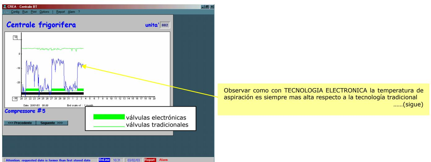
Fig. 15: Datos de la temperatura de ASPIRACION de los compresores de la central frigorífica BT relativos al PERIODO 20ene-3feb 2003
