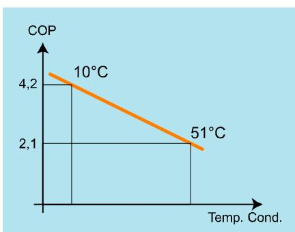
Fig.2: Valori di COP con temp evap. (-10°C)
