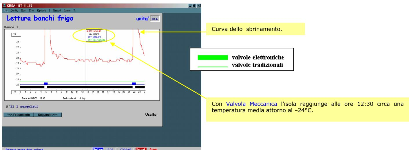
Fig. 13: Ingrandimento su scala GIORNALIERA della temperatura di lavoro dell'isola surgelati n°11 funzionante con VALVOLA MECCANICA.
