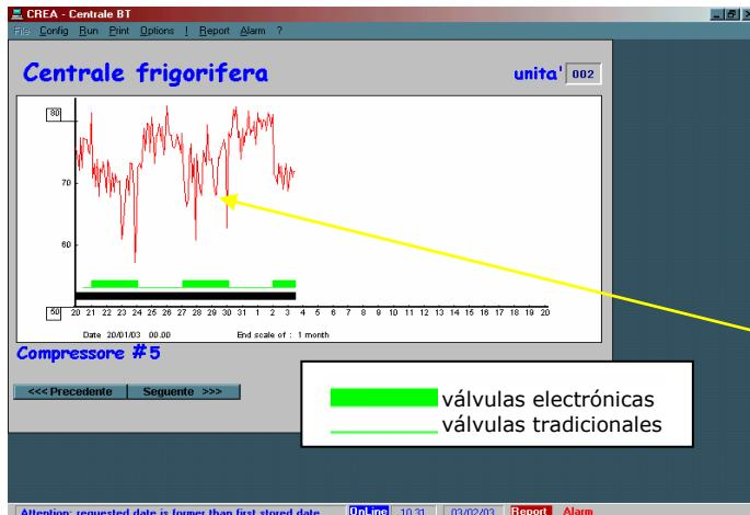
(sigue).....manteniendo una temperatura de descarga INFERIOR, con menor deterioro de los órganos mecánicos y del aceite lubricante
