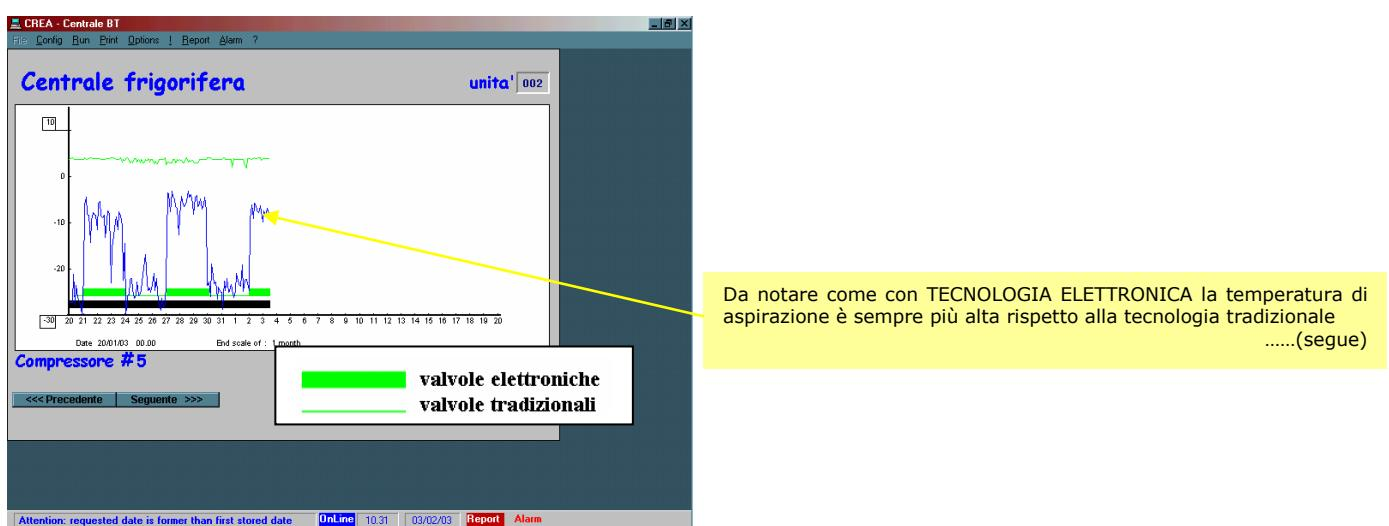
Fig. 15: Dati sulla temperatura di ASPIRAZIONE dei compressori della centrale frigorifera BT relativi al PERIODO 20gen-3feb 2003
