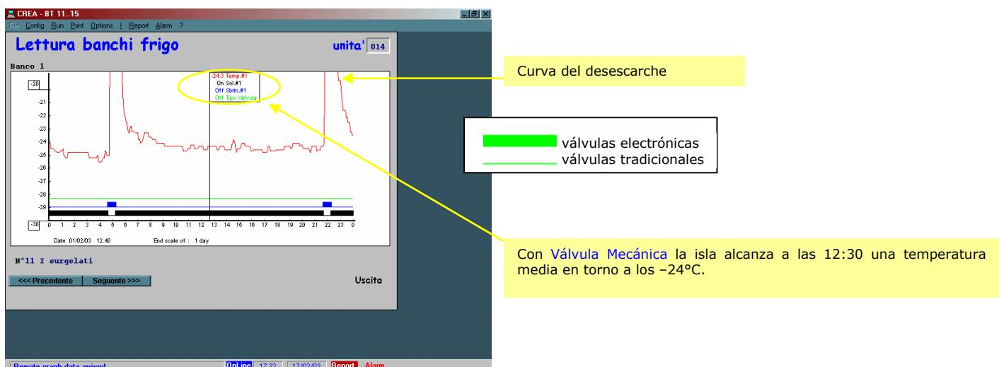
Fig. 13: Ampliación de la escala DIARIA de la temperatura de trabajo de la isla de congelados n°11 funcionando con VALVULA MECANICA.
