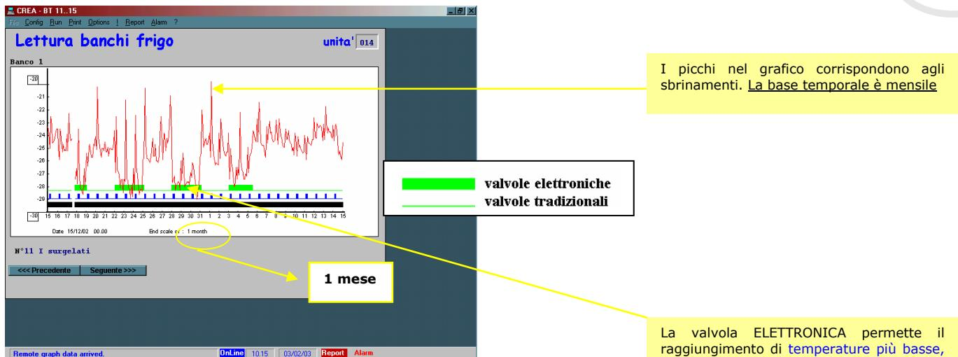
Fig. 12: Temperature di lavoro dell'utenza: "isola surgelati" nel PERIODO 15dic-15gen
