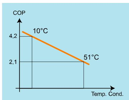
Abb. 2: COP-Werte mit Verdampfungstemperaturen (-10°C)
