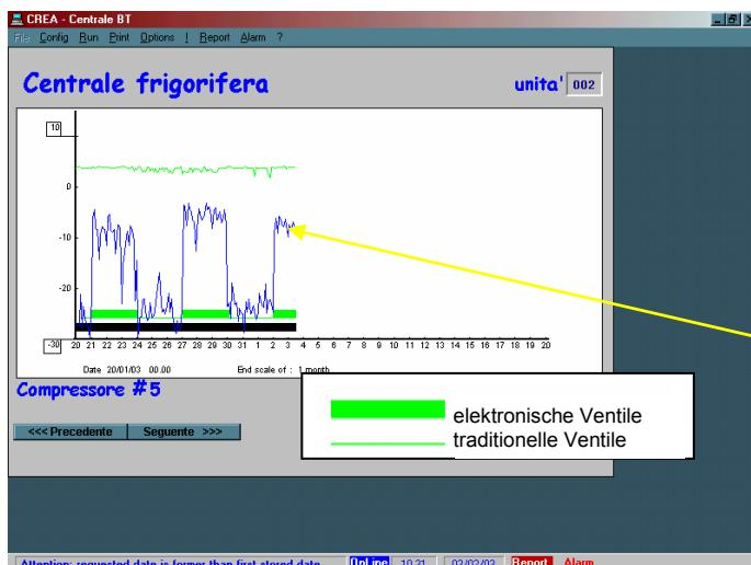
Abb. 15: SAUGTEMPERATUREN der Tiefkühlwanlagenverdichter im ZEITRAUM 20. Jan-3. Feb 2003
