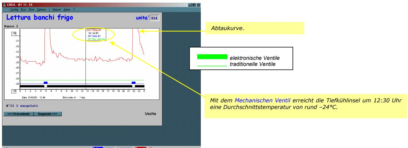
Abb. 13: Vergrößerung auf TAGESBASIS der Betriebstemperatur der Tiefkühlinsel Nr. 11 mit MECHANISCHEM VENTIL.
