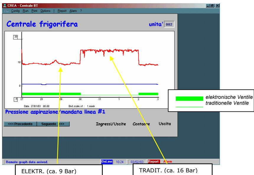
Abb. 10: Verdichterdruckwerte der Tiefkühlanlage in der WOCHE VOM 27. Jan-3. Feb 2003
