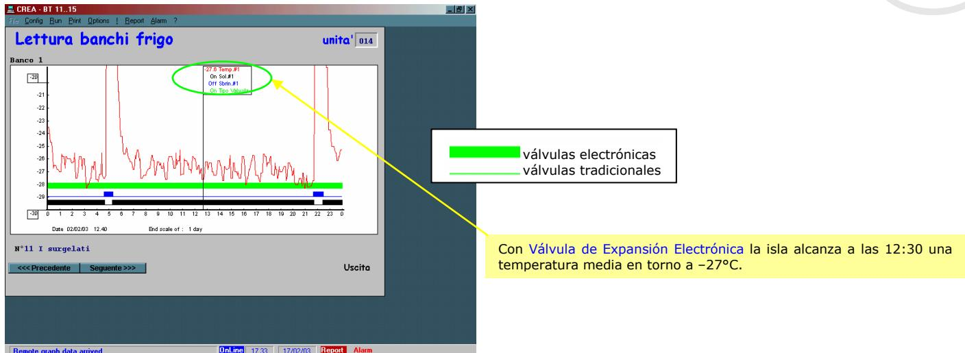
Fig. 14: Ampliación de la escala DIARIA de la temperatura de trabajo de la isla de congelados nº11 funcionando con VALVULA ELECTRONICA.
