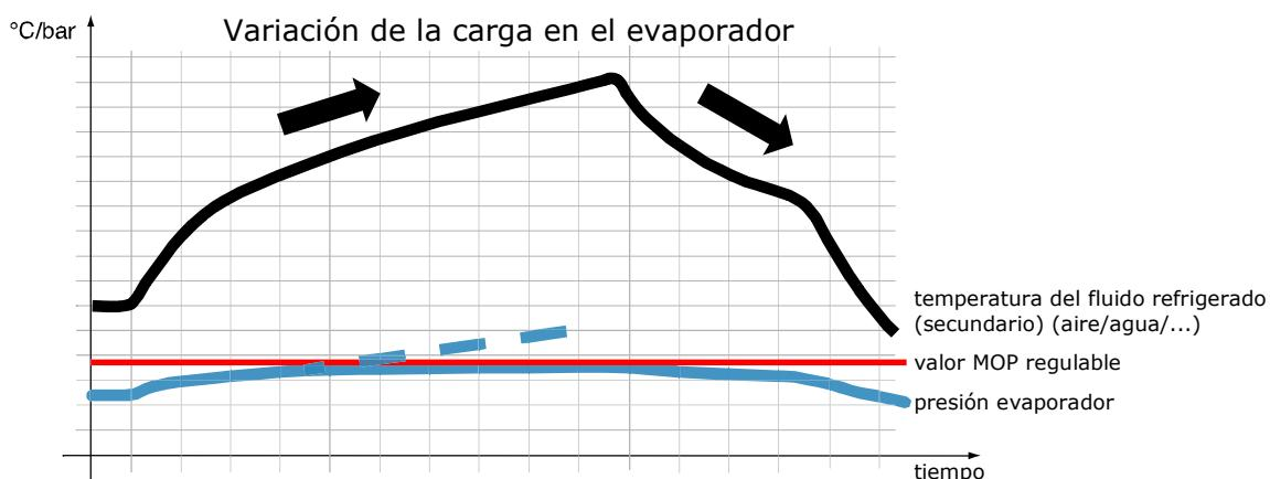
La acción típica de este control se manifiesta con el cierre progresivo de la válvula de expansión, para mantener la presión de evaporación; esto comporta de manera intrínseca un aumento del recalentamiento y de la temperatura del gas en la salida del evaporador (o temperatura del gas sobrecalentado o en aspiración).
