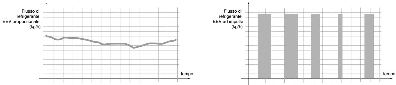
Un'altra notevole differenza tra valvole di tipo proporzionale e PWM è la non propagazione di pulsazioni di pressione sulle linee del refrigerante, particolarmente fastidiose soprattutto in caso di linee molto lunghe (es. supermercati) e presenza di scambiatori di calore liquido-gas. Le pulsazioni di pressione possono portare a malfunzionamenti non tanto nelle EEV stessa quanto nel sistema di connessioni nel suo complesso (linea del liquido, distributore, evaporatore, scambiatore di calore,...).
