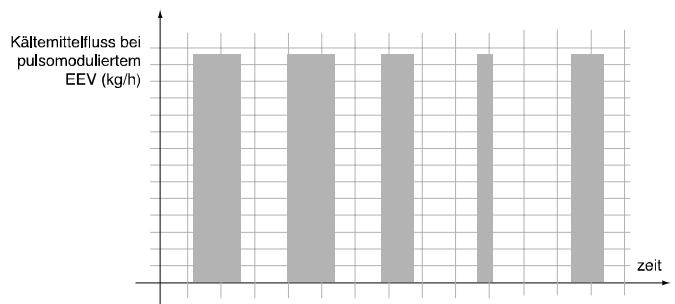
Ein weiterer bedeutender Unterschied zwischen Proportionalventilen und PWM-Ventilen besteht in der Übertragung der Druckpulse in den Kältemittelleitungen, die besonders bei sehr langen Leitungen (in Supermärkten) und bei Flüssig-Gas-Wärmetauschern störend wirken. Die Druckpulse führen zu Funktionsstörungen nicht so sehr im EEV als im Anschlussystem (Flüssigkeitsleitung, Verteiler, Verdampfer, Wärmetauscher, etc.).
