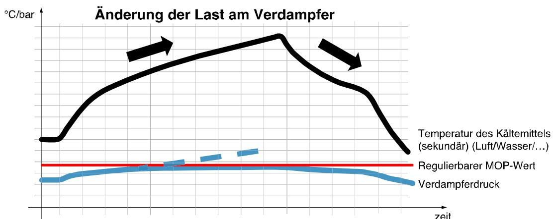
Die typische Aktion dieser Steuervorrichtung ist die fortlaufende Schließung des Expansionsventils, um den Verdampfungsdruck einzuschränken: dies führt zur Erhöhung der Überhitzung und Gastemperatur am Verdampferaustritt (oder der Temperatur des überhitzten Gases oder Sauggases).
