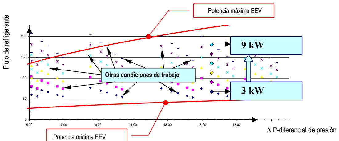
Sobre el grafico han sido trazados los rendimientos de varios compresores (desde 3 a 9 Kw., en condiciones nominales para el acondicionamiento<sup>29</sup>); los puntos de mayor tamaño representan las condiciones nominales.
