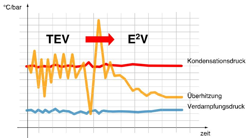
→ Die Verminderung des Überhitzungssollwertes hat oft die Erhöhung der Kühlleistung der Anlage mit folglichem Anstieg des Verdampfungsdruckes und eine bessere Nutzung der Tauschfläche des Verdampfers zur Folge<sup>24</sup>.
