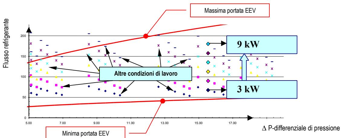
Sul grafico sono state tracciate le rese di vari compressori (da 3 a 9kW in condizioni nominali per il condizionamento<sup>13</sup>): i punti di dimensione maggiore rappresentano le condizioni nominali.
