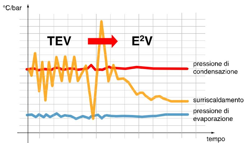
→ La riduzione del set-point del surriscaldamento ha spesso come conseguenza l'aumento della resa frigorifera dell'unità per il conseguente aumento della pressione di evaporazione e per il migliore sfruttamento della superficie di scambio dell'evaporatore<sup>16</sup>.
