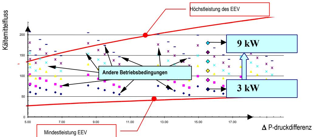
Das Diagramm zeigt die Leistungen der verschiedenen Verdichter (von 3 bis 9 kW bei Nominalbedingungen für die Klimaanwendungen<sup>21</sup>): die größeren Punkte stellen die Nominalbedingungen dar.
