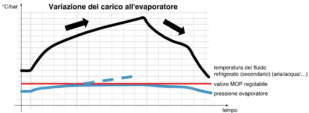
L'azione tipica di questo controllo si manifesta con una chiusura progressiva della valvola di espansione, in modo da contenere la pressione di evaporazione: questo comporta in maniera intrinseca un aumento del surriscaldamento e della temperatura del gas in uscita dell'evaporatore (o temperatura del gas surriscaldato o in aspirazione).
