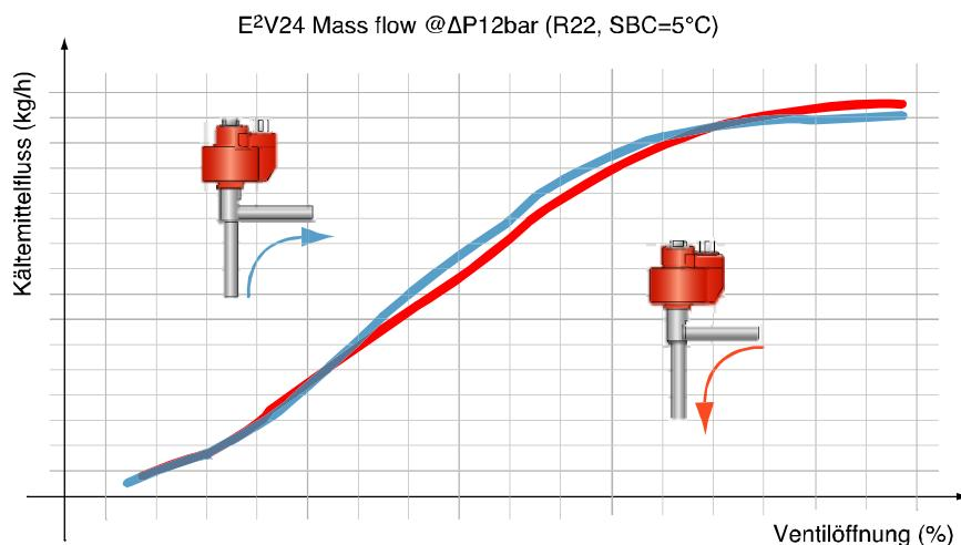
Hier wird die fast perfekte Linearität des Durchflusses mit der Öffnung sowohl bei hohen als auch tiefen Werten offensichtlich.
